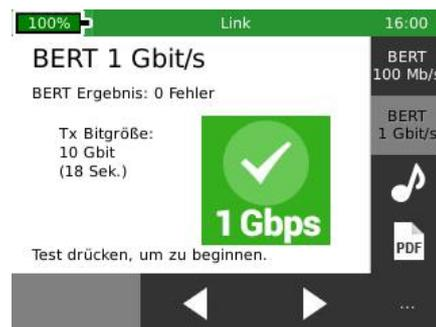
Die BERT-Test-Funktion erlaubt die manuelle Durchführung eines Bit Error Rate Tests ohne auf die Vorgaben wie z.B. Längenmaxima und Pinbelegung zu achten. Dies erlaubt die Prüfung, ob ein Kabel 100Mbps oder 1Gbps unterstützt mit bis 250 Gigabyte Daten.
