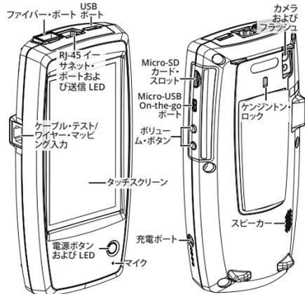
LinkRunner G2は、Android ベースのネットワーク・テストおよびトラブルシューティング・ツールです。ネットワークの可用性とケーブルの接続の検証が簡単で、ネットワークとポートの特定を行えます。また、他の NETSCOUT テスターから実施する性能テストのパケット・リフレクターとして LinkRunner G2 を使用することもできます。
