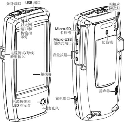
LinkRunner G2 是一款基于 Android 系统的网络测试和故障排查工具。该工具让网络专家能够轻松验证网络的可用性和电缆的连通性，以及轻松识别网络和端口。LinkRunner G2 还可在其他 NETSCOUT 测试仪执行的性能测试中用作包反射器。
